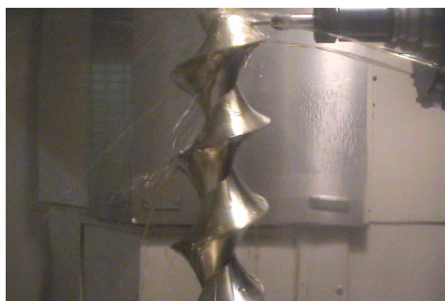
図 14 (1) アルミ製の Clebsch 曲面 (2) Dini 曲面の制作 (協力：ヤマダ精機)
