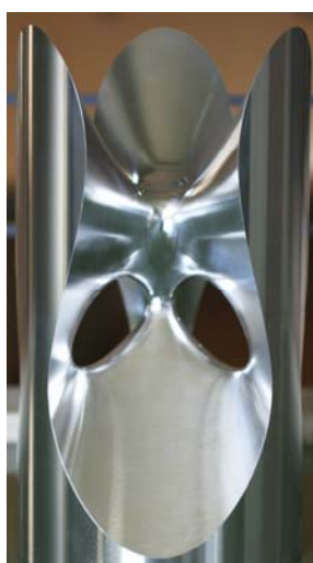
図 14 (1) アルミ製の Clebsch 曲面 (2) Dini 曲面の制作 (協力：ヤマダ精機)
